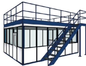
Raumlösung unter einer Stahlbaubühne
