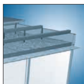
Deckenisolierung mit Mineralwolldämmung (40 mm stark)
