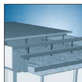
Eindeckung der Decke mit Holzwerkstoffplatte (16 mm stark), begehbare Konstruktion
