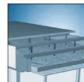
Eindeckung der Decke mit Holz- werkstoffplatte (16mm stark), begehbare Konstruktion
